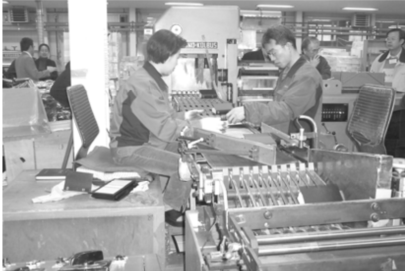
Vérification du placement de la couverture par la machine
